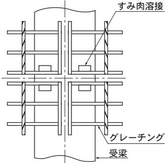
A型サドルクリップを溶接し固定する
