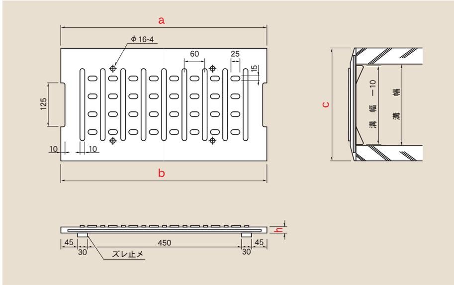
ラバーボードは、耐候性ゴムE.P.D.Mの一体成型品で、弾力性に優れています。転んだ場合でもゴム素材が衝撃を最小限に抑えられるので小さな子供たちが走り廻る学校・幼稚園等で安心してご使用して頂けるグレーチングです。
