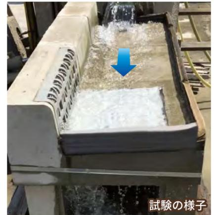
**試験結果** グレーチング部が完全に塞がれてもカバー部から排水可能です。
